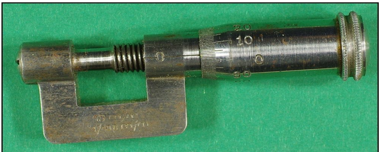
Le palmer servant à mesurer l'épaisseur des lames d'acier
